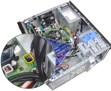
6. Remova o cabo da chave liga/desliga dos cliques do chassi.
