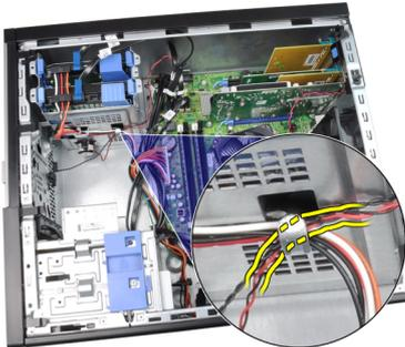
5. Pressione a aba de fixação do alto-falante para baixo e deslize o alto-falante para cima para removê-lo.
