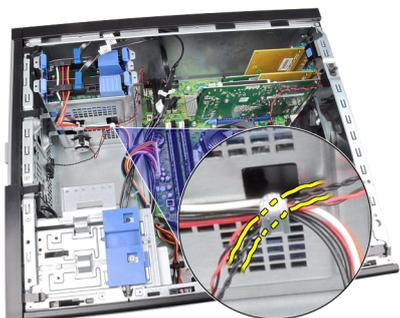
5. Afaste cuidadosamente o sensor térmico da frente do chassi e remova-o.
