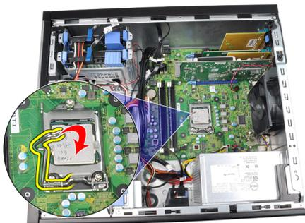
8. Levante o processador para removê-lo do soquete e coloque-o em uma embalagem antiestática.
