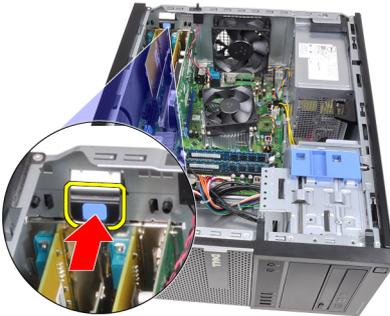
4. Afaste delicadamente a alavanca de liberação da placa PCIe x16 até soltar a aba de fixação do entalhe na placa. Em seguida, solte a placa de seu conector e remova-a do computador.
