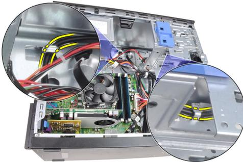
7. Remova o cabo da chave liga/desliga do clipe do chassi.
