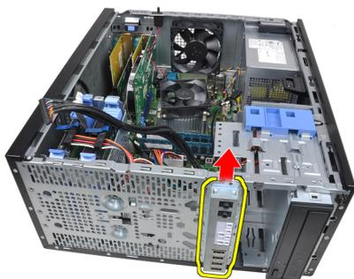
8. Remova o painel de entrada/saída passando o cabo através da frente do computador.
