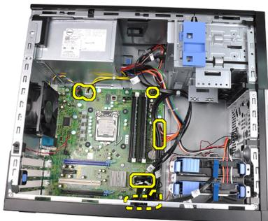
7. Remova os parafusos que fixam a placa de sistema ao computador.
