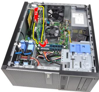
5. Solte a placa de expansão PCIe x1 (se houver) de seu conector e remova do computador.
