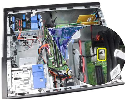
4. Remova o cabo do sensor térmico do clipe do chassi.
