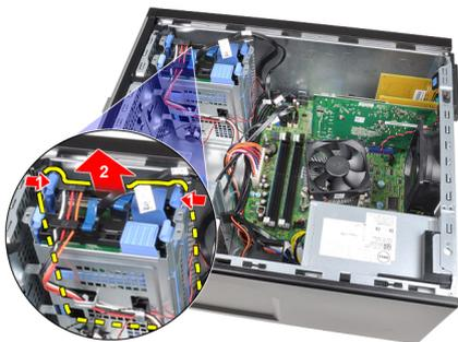
5. Flexione o suporte do disco rígido e remova o disco rígido do suporte.
