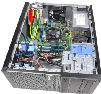
7. Solte a placa de expansão PCI x4 (se houver) de seu conector e remova do computador.
