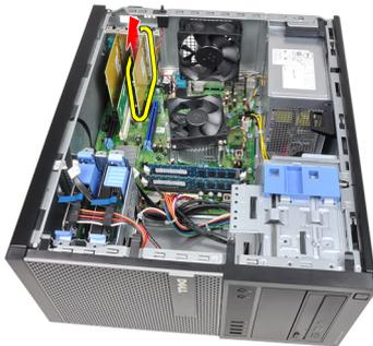
6. Solte a placa de expansão PCI (se houver) de seu conector e remova do computador.
