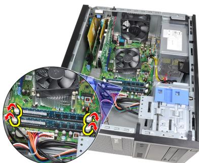
4. Remova os módulos de memória dos conectores na placa de sistema.
