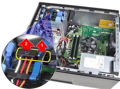
4. Pressione ambas as presilhas azuis de suporte de fixação para dentro e remova o suporte do disco rígido do compartimento.
