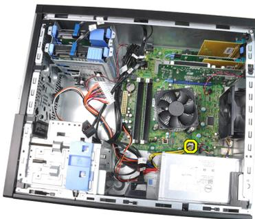
7. Remova os quatro parafusos que prendem a fonte de alimentação à parte de trás do computador.
