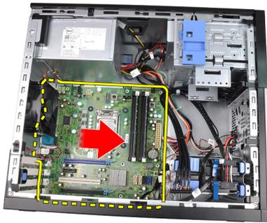
9. Incline cuidadosamente a placa de sistema em 45 graus e, em seguida, remova-a do computador.
