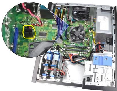
4. Deslize o sensor de violação em direção à parte inferior do chassi e remova-o.
